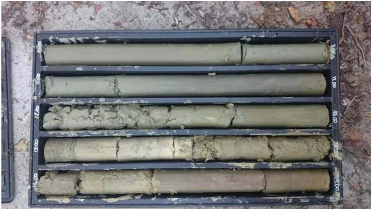
Foto 17: Sondaggio 6 da 10 a 15 m
