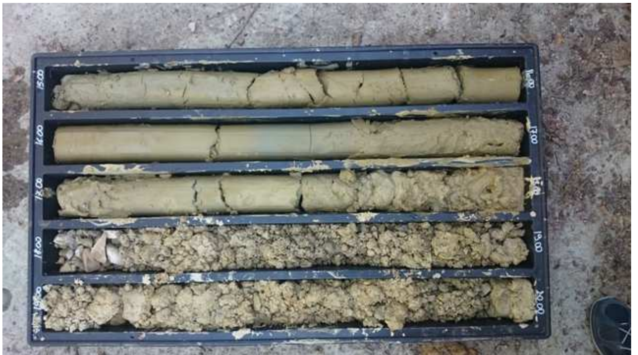
Foto 18: Sondaggio 6 da 15 a 20 m
