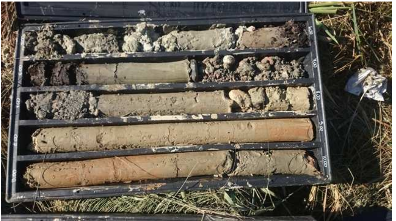
Foto 6: Sondaggio 3 da 5 a 10 m
