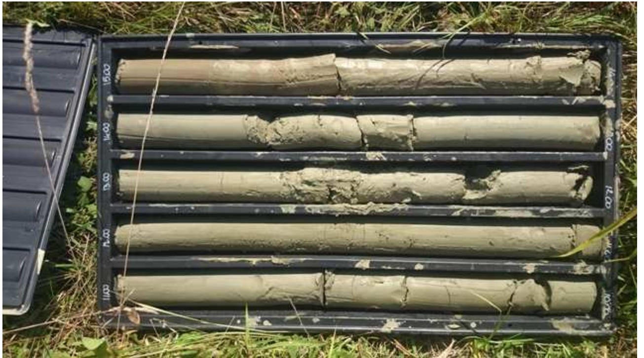
Foto 31: Sondaggio 9 da 10 a 15 m
