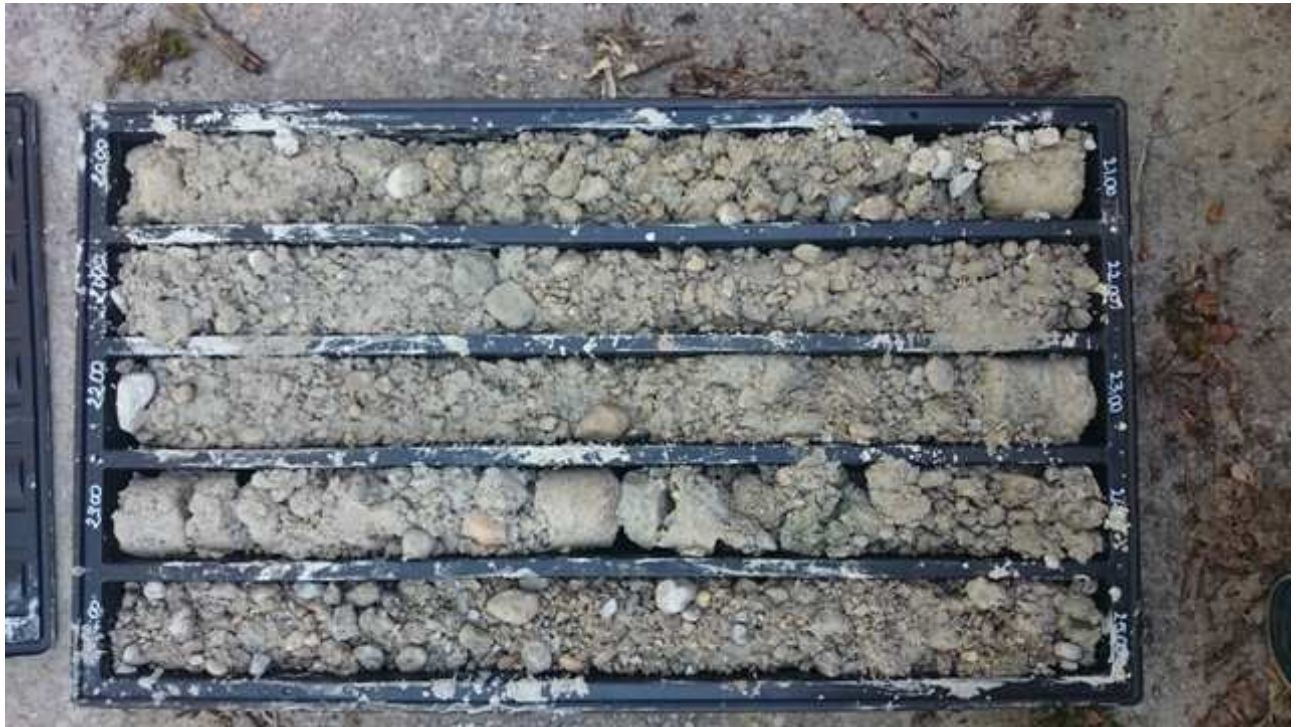
Foto 19: Sondaggio 6 da 20 a 25 m
