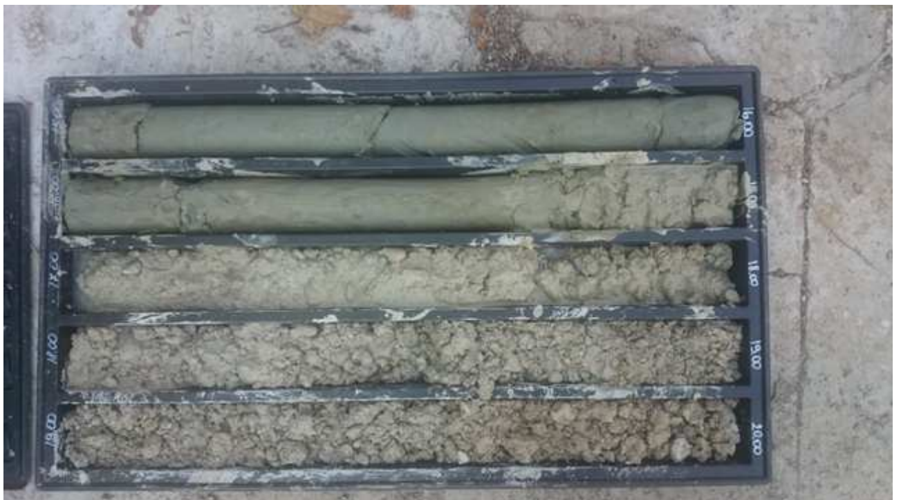
Foto 24: Sondaggio 7 da 15 a 20 m
