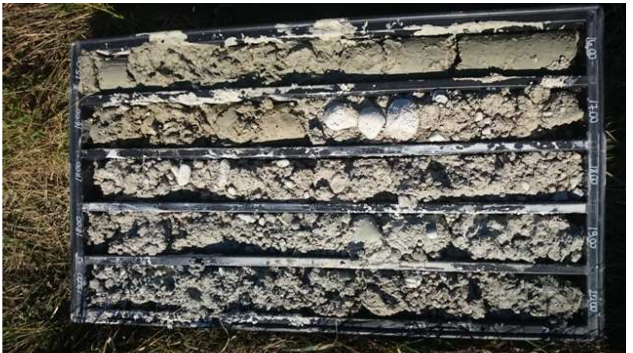
Foto 12: Sondaggio 4 da 15 a 20 m
