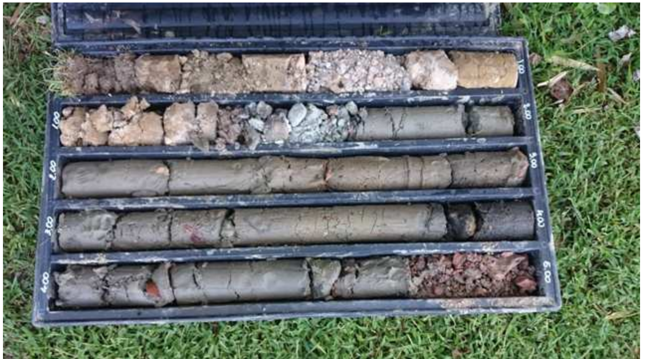
Foto 1: Sondaggio 1 da 1 a 5 m
