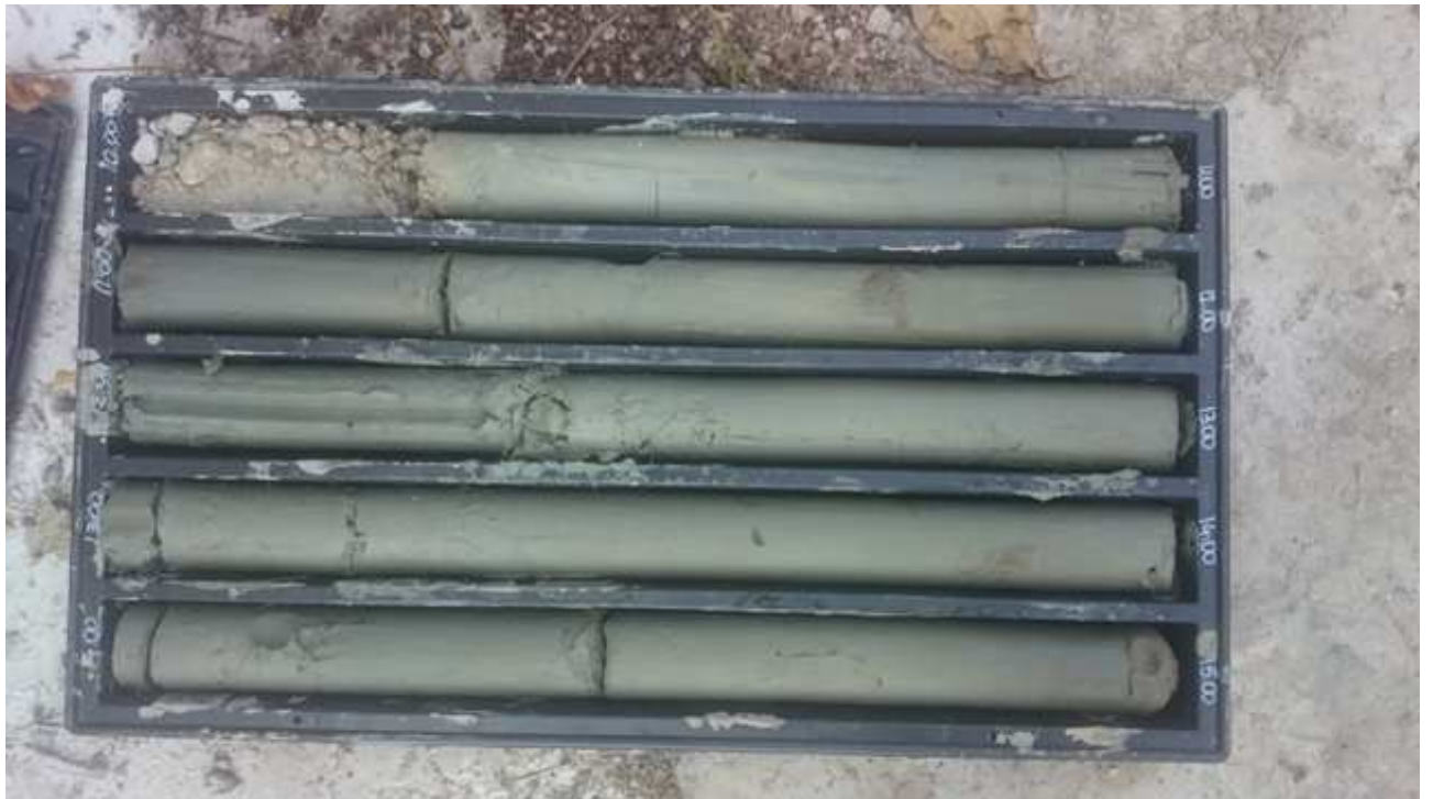
Foto 23: Sondaggio 7 da 10 a 15 m
