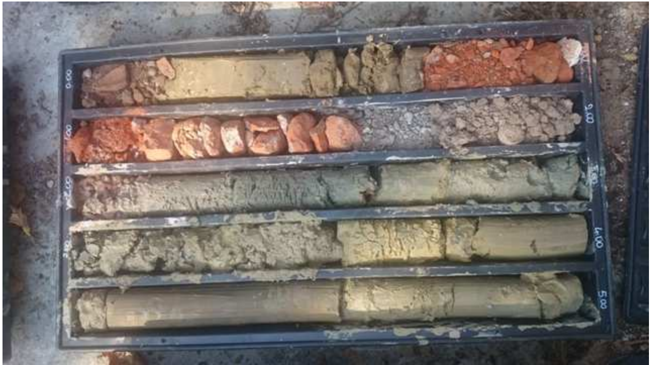
Foto 21: Sondaggio 7 da 1 a 5 m
