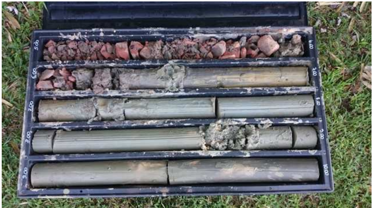
Foto 2: Sondaggio 1 da 5 a 10 m
