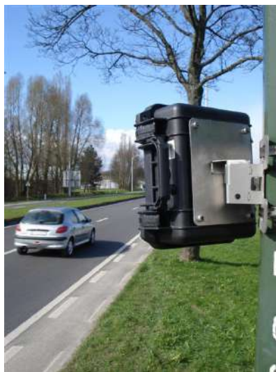
Figura 19: Esempio strumentazione radar Icoms TMS-SA4
