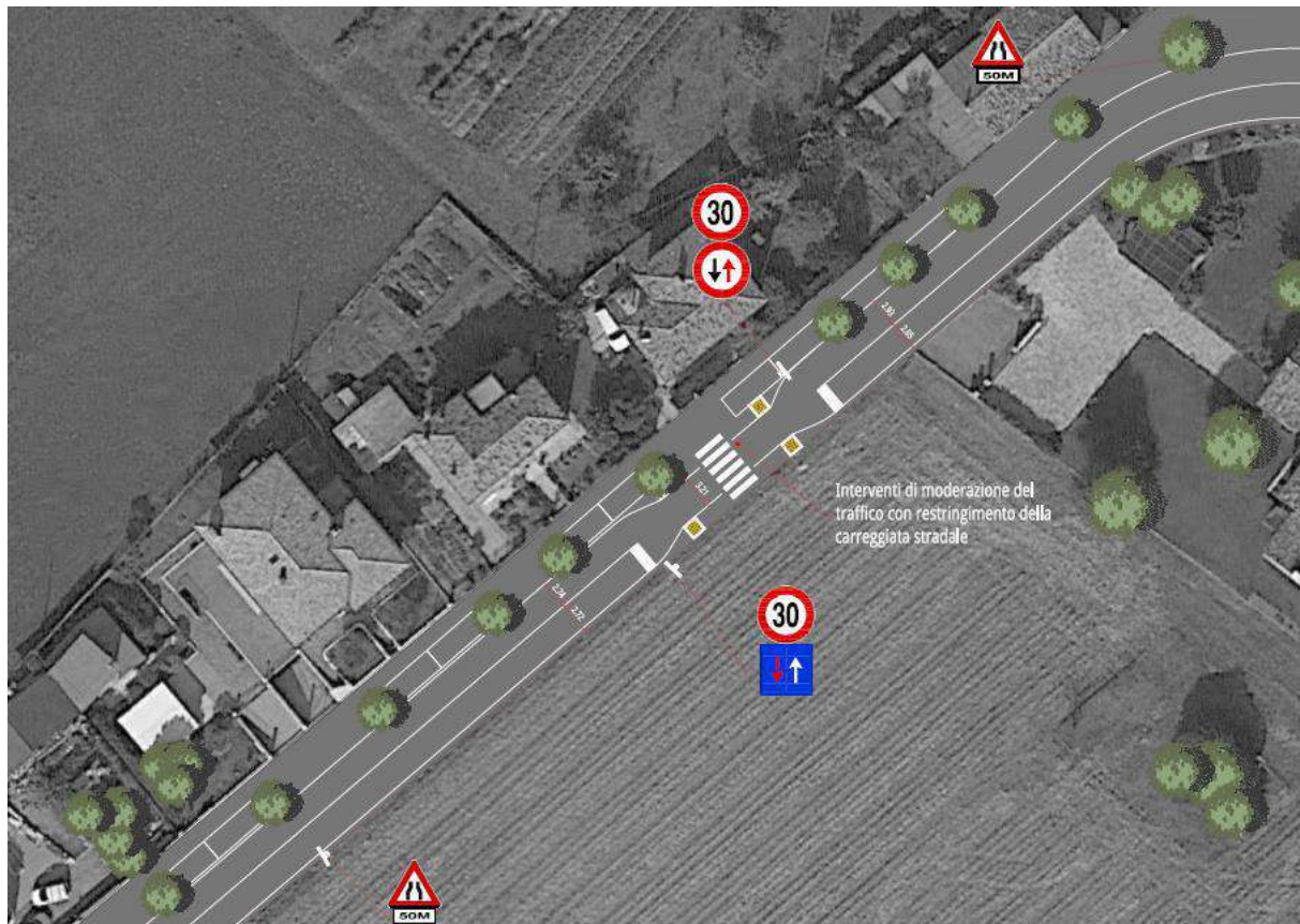
Figura 23: Restringimento carreggiata in via Santa Rosa
