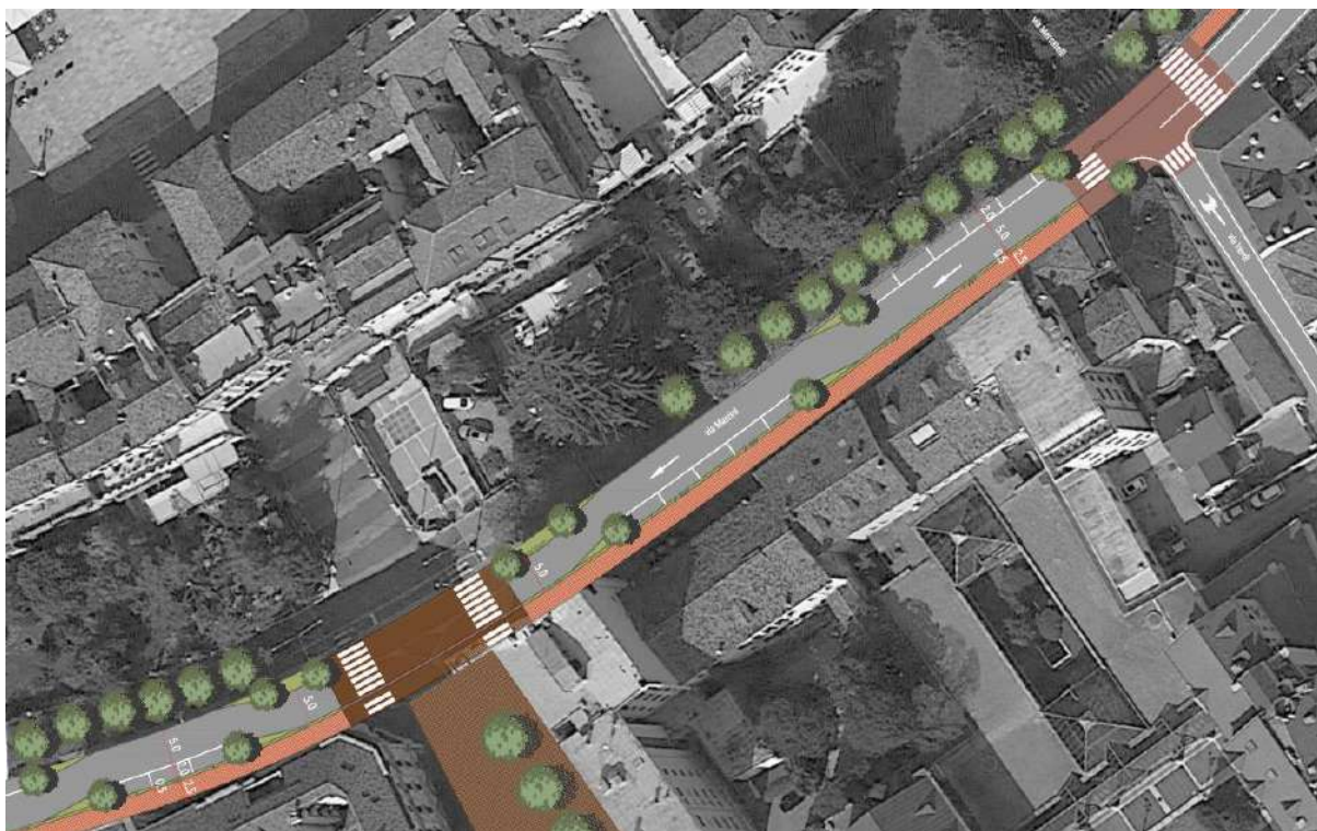
Figura 15: Interventi di moderazione del traffico in via Mazzini
