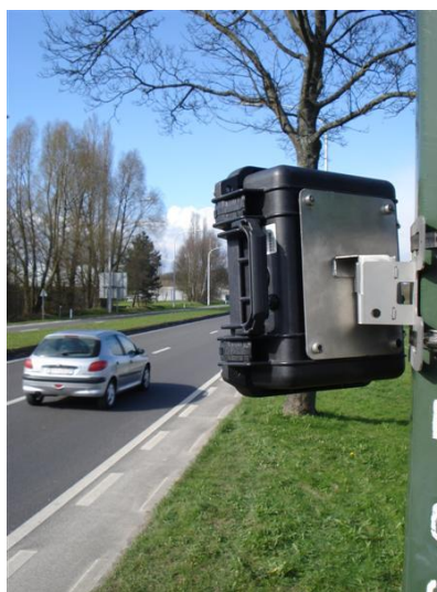
Figura 19: Esempio strumentazione radar Icoms TMS-SA4
