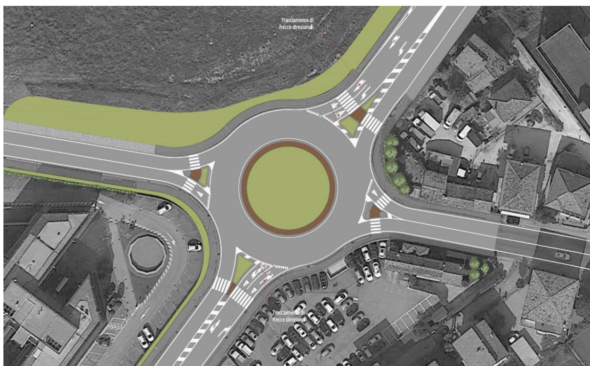
Figura 22: Realizzazione frecce direzionali in viale Italia, nella rotatoria con via Matteotti e via Resistenza
