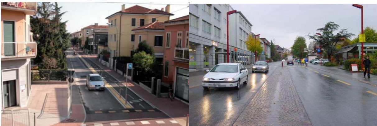
Figura 42: Esempi riserve centrali sormontabili e semi sormontabili
